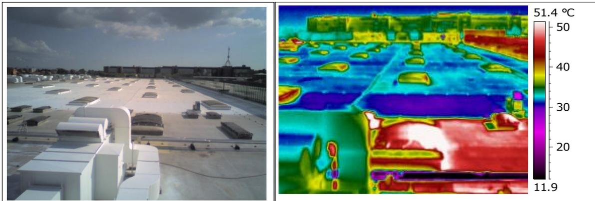
Nelle ultime immagini che riportano la vista della copertura lungo il lato OVEST la fascia a colorazione più scura si estende fino al lato SUD poiché la superficie subisce l'ombra proiettata da una struttura verticale.
